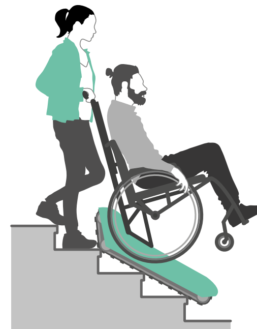
Schodołaz. Urządzenie niezalecane do stosowania w budynkach użyteczności publicznej
