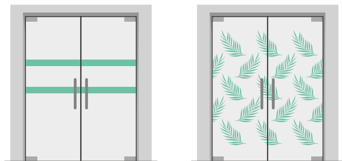
Przykłady oznakowania przegród i ścian transparentnych
