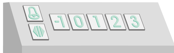
Pochylony panel sterujący, ułatwiający trzymanie przycisku w trakcie korzystania z podnośnika
