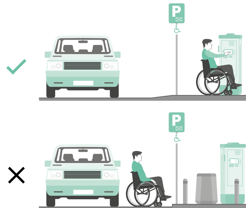
Zapewnienie dostępu do parkomatu. U góry sytuacja prawidłowa, na dole dostęp utrudnia wysoki krawężnik i inne przeszkody
