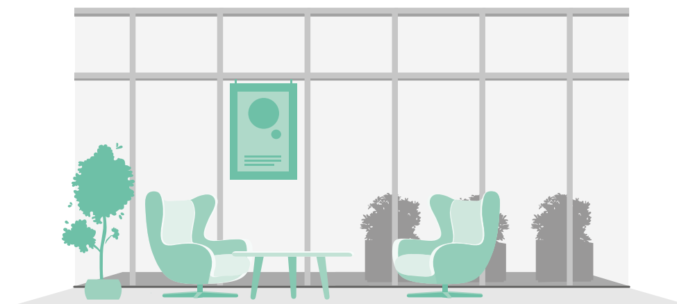
Meble uniemożliwiające bezpośredni dostęp do szklanej ściany zamiast oznaczenia kontrastowego na taflach
